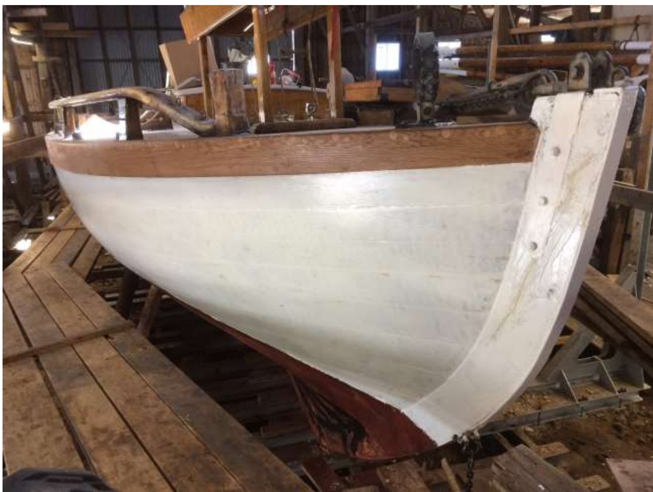
Immanuel med nyrestaurert fribord på slippet i bua på Moen hos Risør Trebåtbyggeri (mai 2019)
